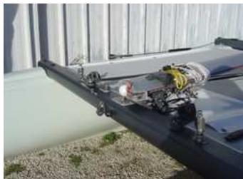
Mettre en place le mât sur le pied de mât situé sur la poutre avant **(2)**,
