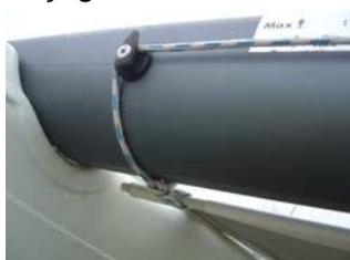
Faire un nœud de chaise sur le jonc arrière (à gauche), puis rejoindre le premier crochet (pion) de la poutre arrière, rejoindre le second crochet puis tourner autour du jonc pour rejoindre à nouveau le second crochet, partir vers le troisième crochet, etc.
