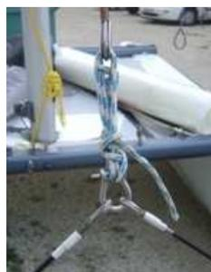
Redresser alors le mât en prenant soit de maintenir le pied de mât sur la boule puis accrocher l'étai **(16)** à la manille de patte d'oie **(24)** avec le bout fourni (le tendre fermement).
