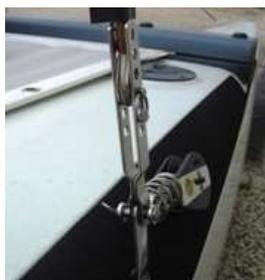
⚠ Attention: les poulies winch sont à fixer sur les lattes ridoirs des haubans (en bas). La manille de fixation des poulies est la même que celle qui fixe les haubans à la cadène.
